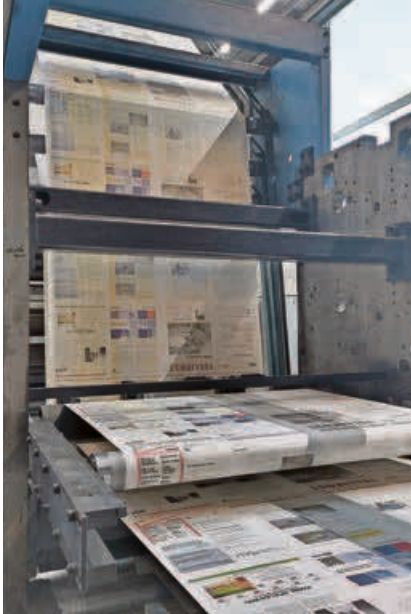
Zusammenführung der Papierbahnen
